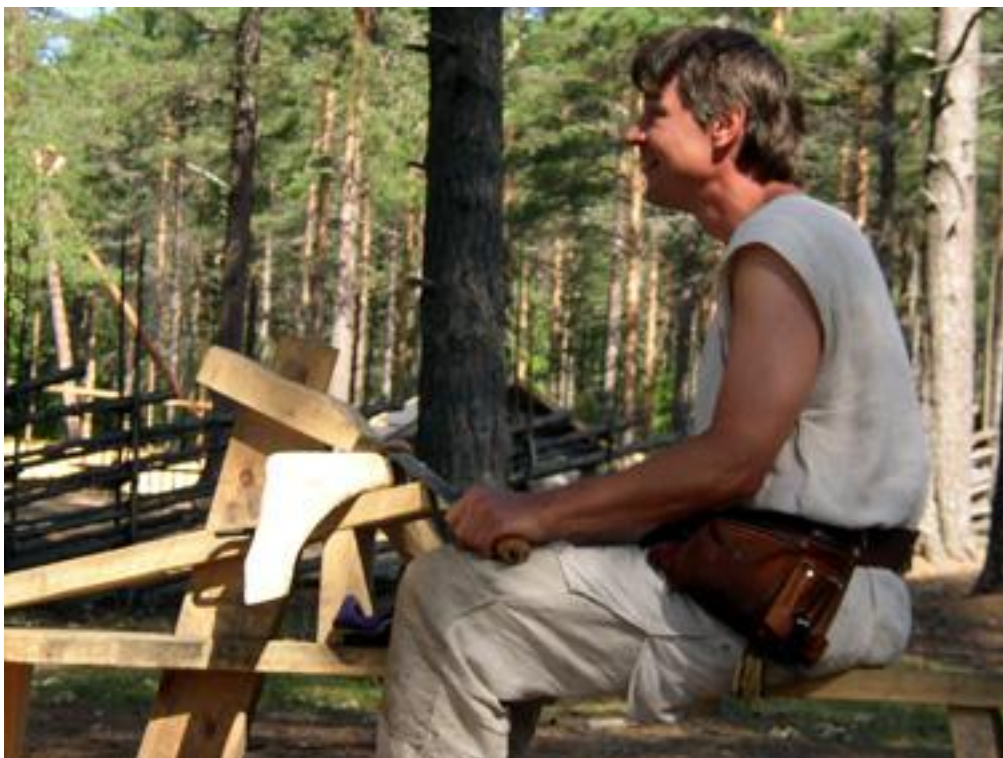
Täljhästen visade sig vara till god hjälp vid tillskärningen av stävar, krin och spant.
